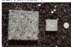
Figure 2 : Exemple de valorisation du vitrifié : dalles en béton + vitrifié
