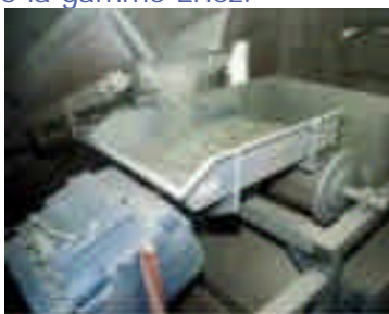
Figure 1 : séparateur à tambour magnétique radial (RR)
