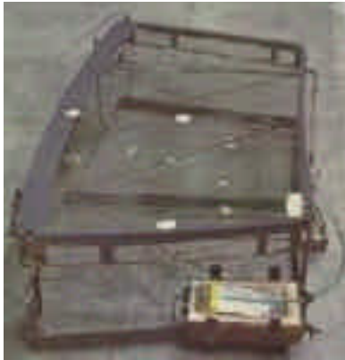
Système Datapaq dans une arche. Des thermocouples sont placés sur toute la largeur du four.
