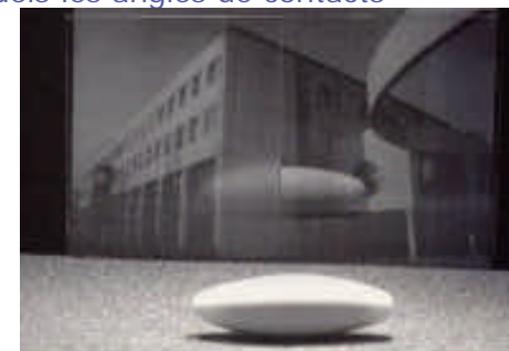
Figure 7. Verre recouvert d'un revêtement d'ITO antireflet-antistatique (côté gauche) et non-traité (côté droit)
